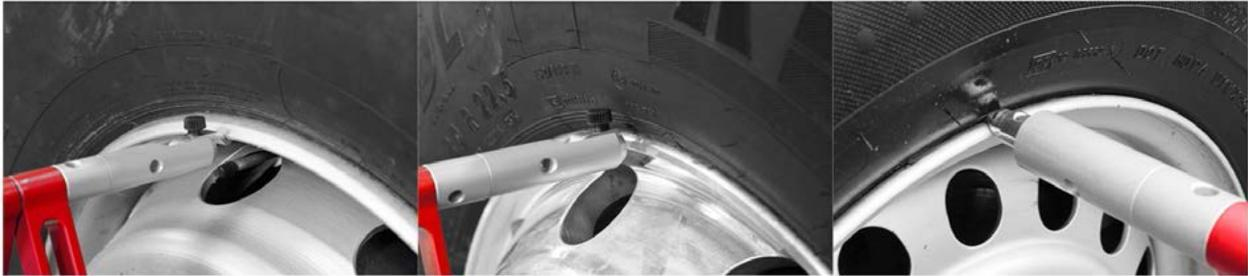
Sie werden durch Anpassen der Haken am Ende der Radadapterbeine, entweder auf der Innenseite der Felge oder zwischen Felge und Reifen, je nach Felge, angebracht. Durch Drehen des Knopfes auf der Seite des Adapters wird dieser befestigt. Für leichte Nutzfahrzeuge, zum Beispiel Vans, Transporter usw., verwenden Sie das kleinere Bein mit dem Van-Haken für den Radadapter und platzieren Sie es zwischen Felge und Reifen.
