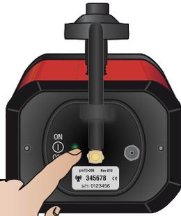
Die Software verfügt über eine integrierte Funktion zur Überprüfung und Kalibrierung der Kameras. Diese Kalibrierung wird an dem Fahrzeug, das gemessen wird, unter Verwendung des Standard-Messgeräts durchgeführt. Falls erforderlich, starten Sie das Gerät durch Drücken der Taste EIN/AUS auf der Rückseite der Kamera. Folgen Sie den Schritten, die in dem Hilfstextfeld auf dem Computerbildschirm aufgeführt sind:
