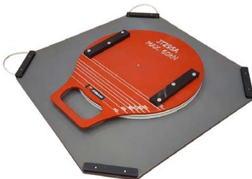
Zur Beseitigung der Reibung zwischen Boden und Reifen beim Messen des maximalen Radeinschlags und der Nachlaufschwankungen wird ein Drehteller mit einer reibungsarmen Platte verwendet. Um die Höhe dieser Platten bei der Messung von Nachlauf, Spreizung und Einschlagwinkeln an der Vorderachse auszugleichen, werden für die Hinterachse Höhenausgleichsplatten aus Holz (siehe unten) verwendet. Die Platten sind für ein Gewicht von jeweils bis zu sechs Tonnen geeignet.
