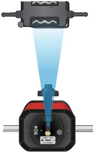
Montieren Sie eine Kamera auf dem Radargestell. Falls nötig, starten Sie die Kamera durch Drücken der EIN/AUS-Taste auf der Rückseite. Richten Sie die Kamera auf den Wabco-Adapter und drücken Sie an der Kamera auf **OK**.
