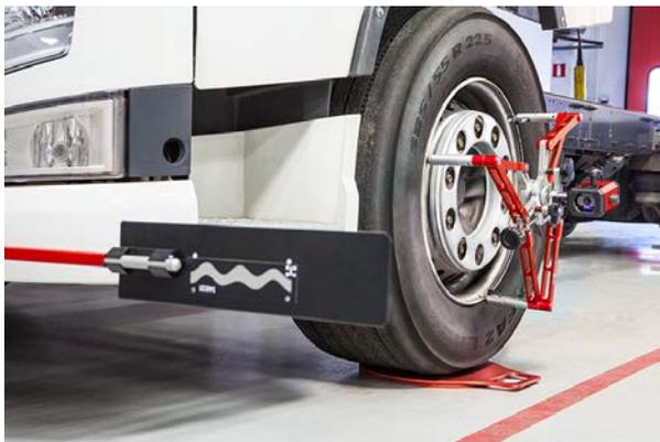
Vergewissern Sie sich, dass die Lenkachse vor dem Start auf reibungsarme Platten abgesenkt wurde.
