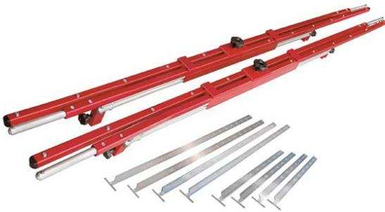
Die Messlineale sind selbstzentrierend. Wenn sie an einem Fahrzeug montiert werden, dienen sie als Mittellinienreferenz des Fahrgestells und damit als Standardreferenz für das Kamera-Radausrichtungssystem.
