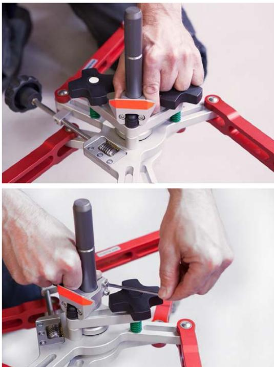
Verwenden Sie einen 4-mm-Inbusschlüssel, um die Befestigungsschrauben am TC-416-Referenzblock zu lockern.
