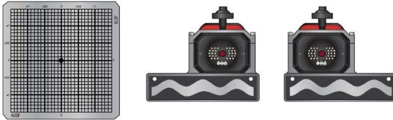
Montieren Sie die entsprechende AZOF ELOF-Skala an der Vorderseite des Lasers. Bringen Sie Kameramarker an beiden Kameras an. Siehe [13.3 „Montage der AZOF/ELOF-Skala“](#), Seite 75.
