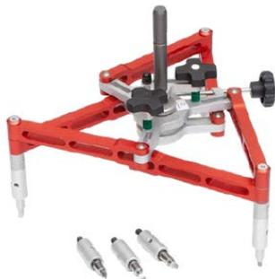
Der Radadapter wird verwendet, um die Kameras an den Rädern des Fahrzeugs zu befestigen. Der Radadapter wurde entsprechend einem Stativ-Prinzip konzipiert, um die höchstmögliche Genauigkeit bei der Messung zu ermöglichen, und kann bei Aluminium- sowie Stahlfelgen in den Größen 12" – 22,5" verwendet werden.
