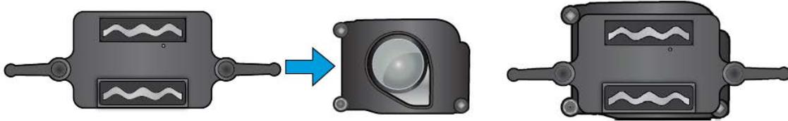
Montieren Sie den Wabco-Adapter am ACC/AICC-Radargerät am Fahrzeug.
